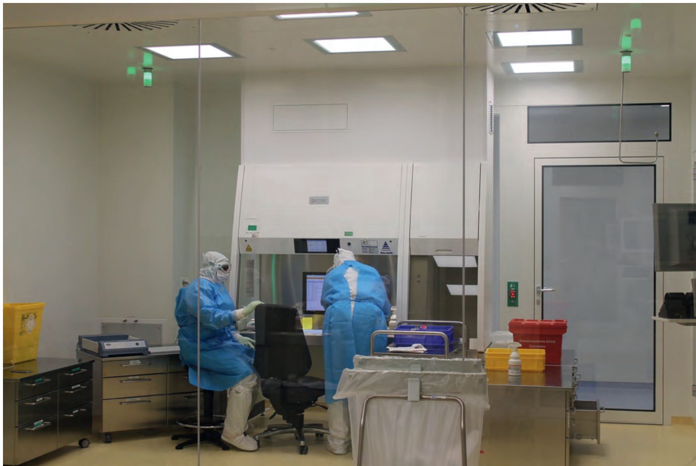
Abbildung 5: Mitarbeitende der Kantonsapotheke Zürich bereiten an der Sicherheitswerkbank Claire® von SKAN die Zytostatikaherstellung vor. An der Decke sieht man Warnlichter, die mit der Sicherheitswerkbank gekoppelt sind. Bei Abweichungen der Partikelmengen und Luftgeschwindigkeiten innerhalb der Anlagen, leuchtet das Licht rot, gut sichtbar für alle im Raum. (Bild: SKAN AG Pure Solutions)
