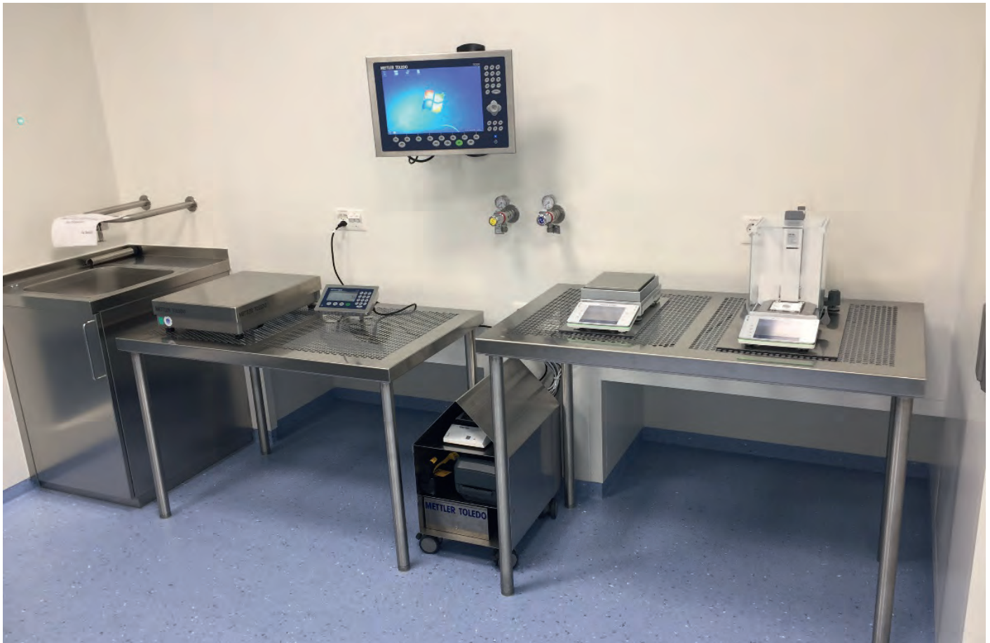
Typischer Wägeplatz: Wägeraum mit Analyse- und Präzisionswaage sowie industrieller Plattform (von rechts nach links). Die Bedieneinheit IND890-15 (Wandmontage) verbindet alle Waagen mit dem Rezeptursystem FormWeigh.Net und führt den Benutzer durch den Prozess. (Foto METTLER TOLEDO)
