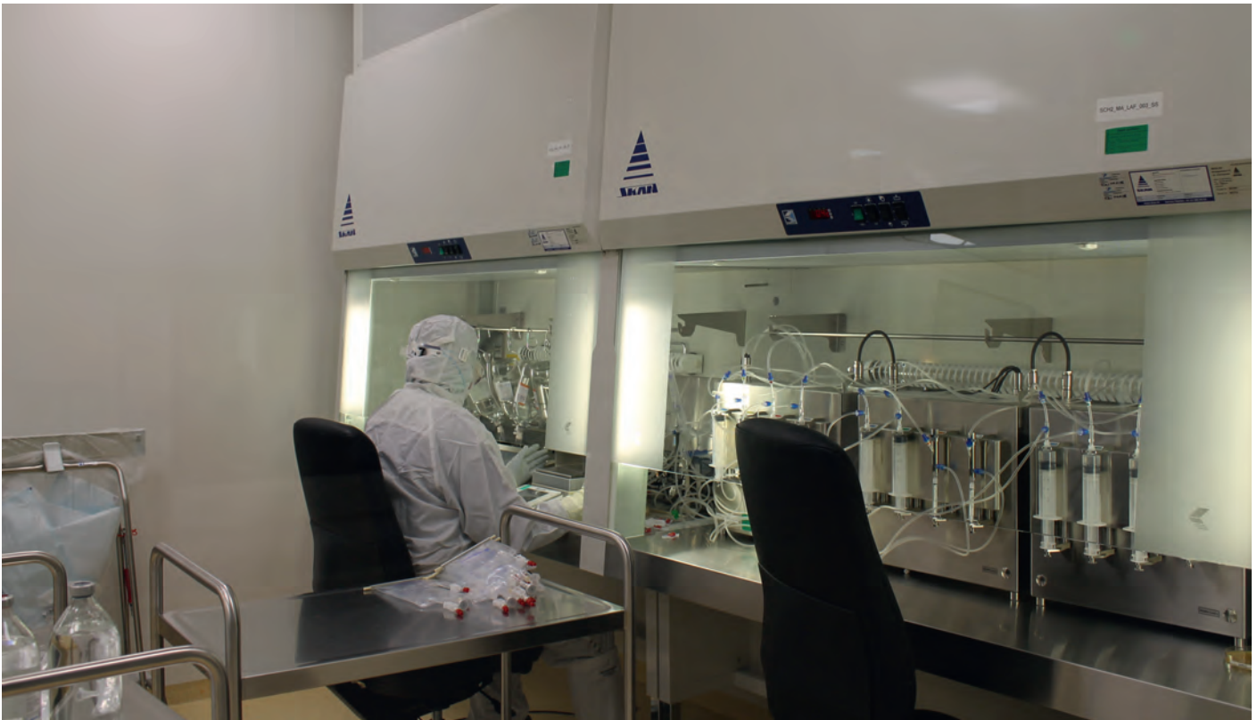
Abbildung 6: In zwei verbundenen SKAN Laminar Flow-Anlagen wird parenterale Ernährung für Säuglinge und Frühgeborene zusammengestellt. (Bild: SKAN AG Pure Solutions)
