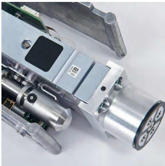
Kraftkompensations-Wägezelle: MonoBloc Wägezelle mit eingebautem Kalibriergewicht. (Foto METTLER TOLEDO)
