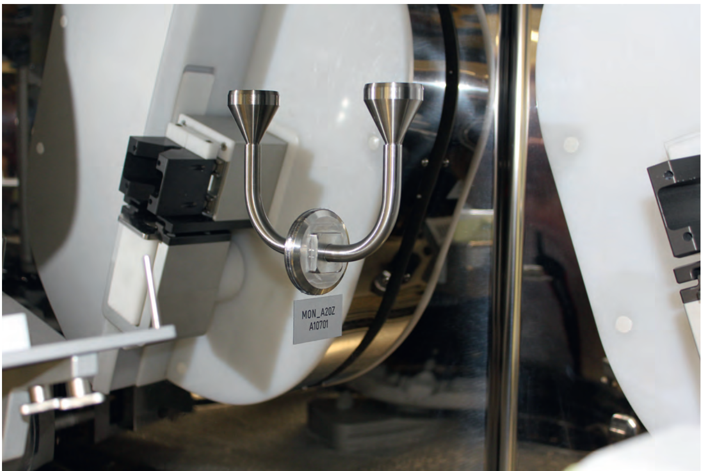
Isokinetischer Probenehmer im Zytoroboter (Zone A). (Foto RETEL Neuhausen AG)
