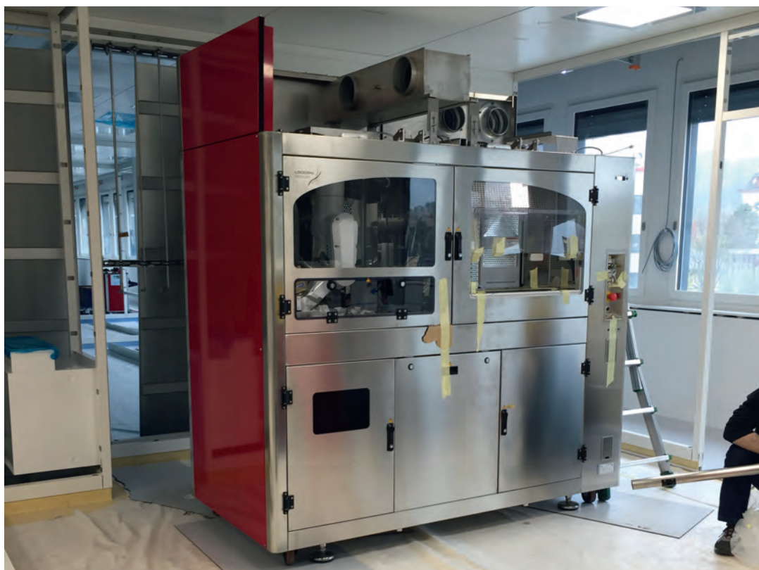
Einer der beiden Roboter zur Herstellung von Zytostatika, nach der Stellung im Raum, vor der Integration in den Reinraum. (Bild: Meili Bauconsulting AG)
